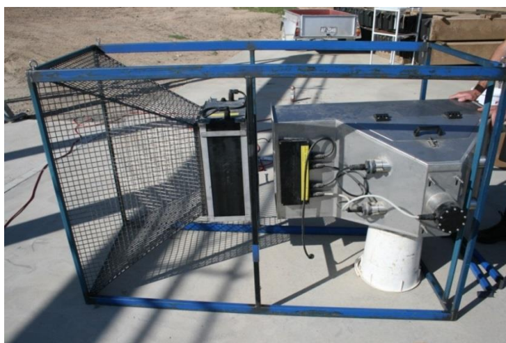
Riverwatcher : caméra submersible connectée
